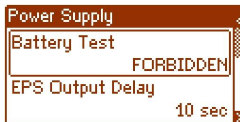
Fig. 29. Battery test – „PROHIBITED”.
